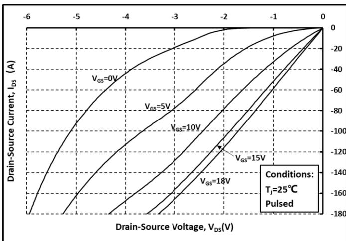
图. 14 第三象限曲线 @  $T_j = 25^\circ\text{C}$
