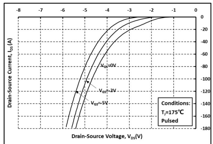
图. 12 体二极管导通曲线 @  $T_j = 175^\circ\text{C}$
