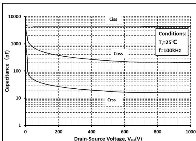
图. 16 各电容和  $V_{DS}$  关系曲线
