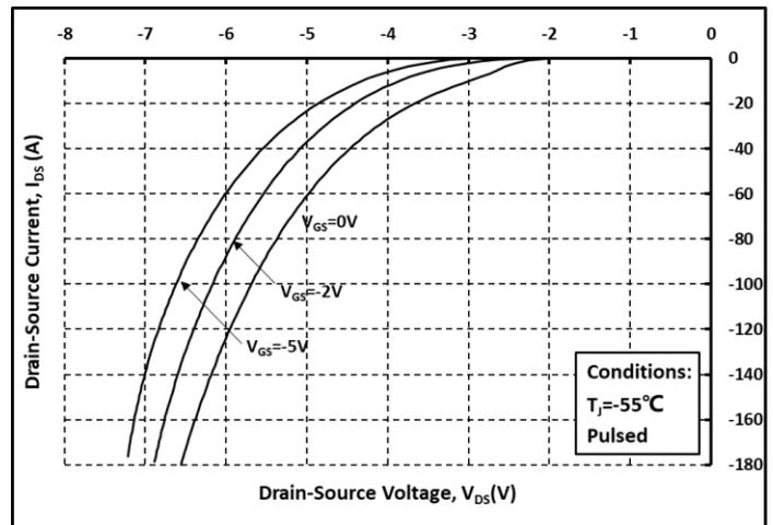
图. 10 体二极管导通曲线 @  $T_j = -55^\circ\text{C}$
