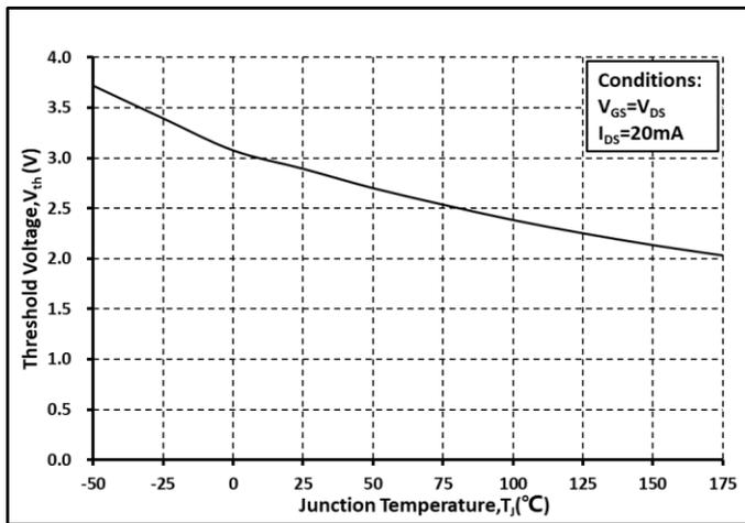
图. 9 阈值电压随温度变化曲线
