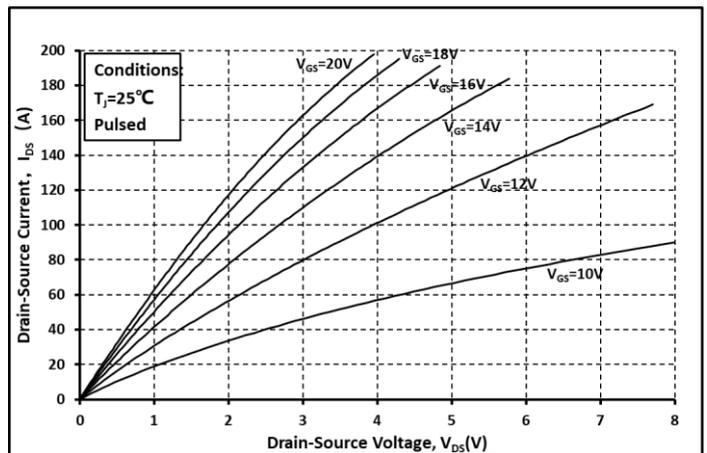
图. 2 输出曲线 @  $T_j = 25^\circ\text{C}$
