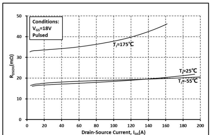
图. 6 各温度下的  $R_{on}$  和  $I_{DS}$  关系曲线
