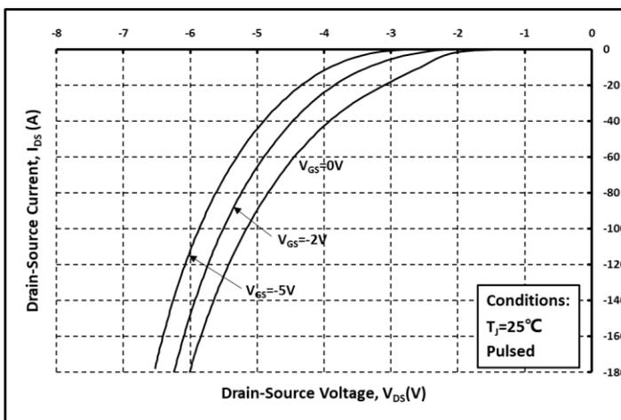
图. 11 体二极管导通曲线 @  $T_j = 25^\circ\text{C}$
