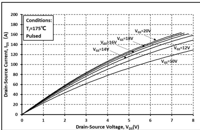
图. 3 输出曲线 @  $T_j = 175^\circ\text{C}$
