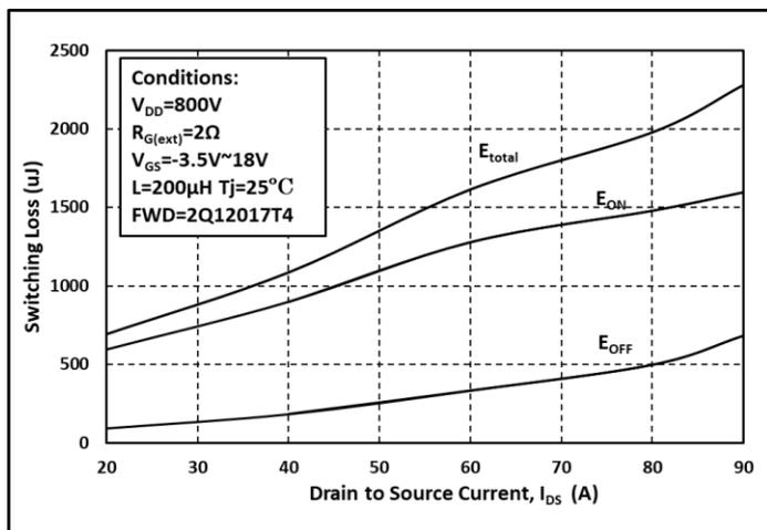
图. 21 开关能量和漏端电流  $I_{DS}$  关系曲线
