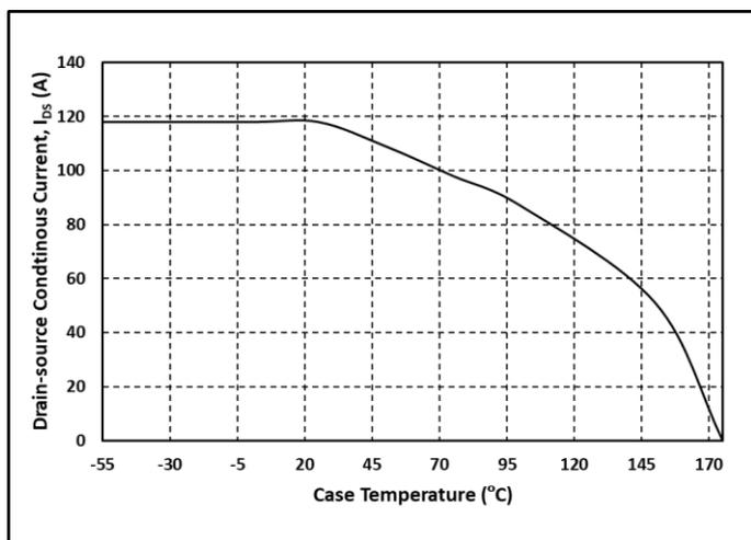
图. 23 漏端电流和温度关系曲线
