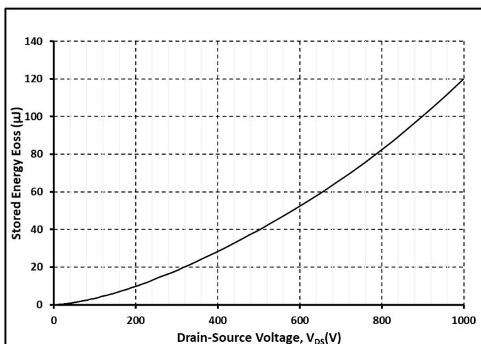
图. 17 输出电容存储能量曲线
