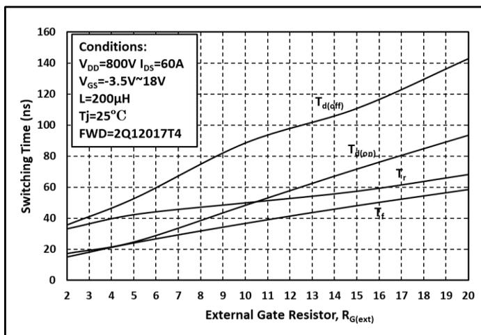
图. 20 开关时间和栅极电阻  $R_{G(ext)}$  关系曲线
