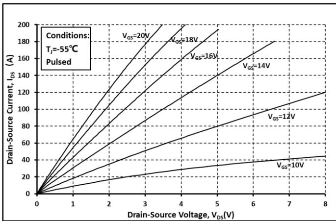
图. 1 输出曲线 @  $T_j = -55^\circ\text{C}$
