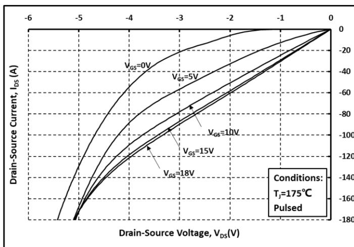
图. 15 第三象限曲线 @  $T_j = 175^\circ\text{C}$
