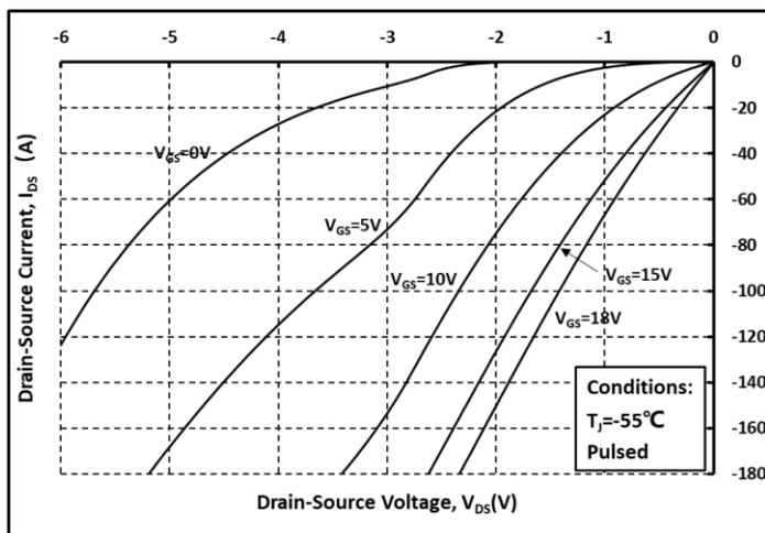
图. 13 第三象限曲线 @  $T_j = -55^\circ\text{C}$
