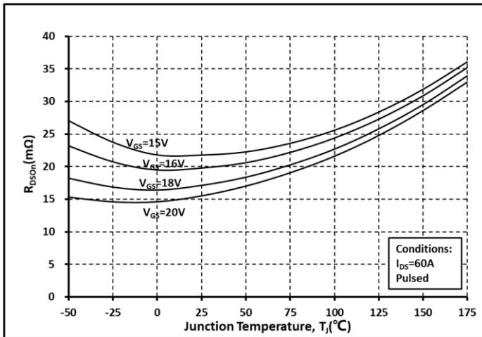
图. 7 各  $V_{GS}$  下的  $R_{on}$  和温度关系曲线
