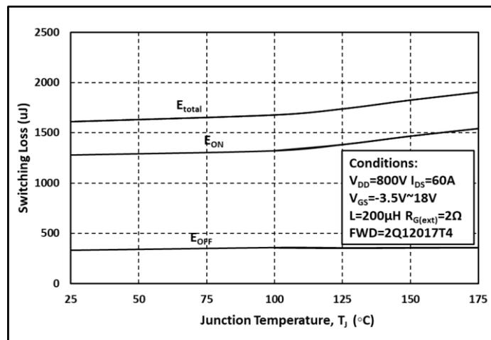
图. 22 开关能量和温度关系曲线
