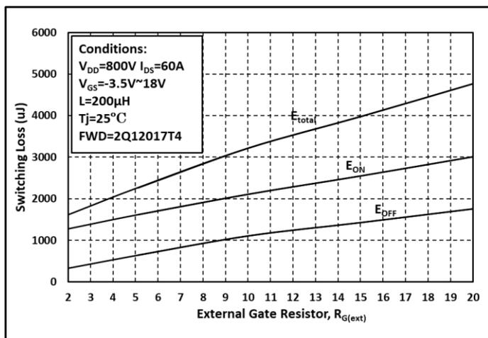
图. 19 开关能量和栅极电阻  $R_{G(ext)}$  关系曲线
