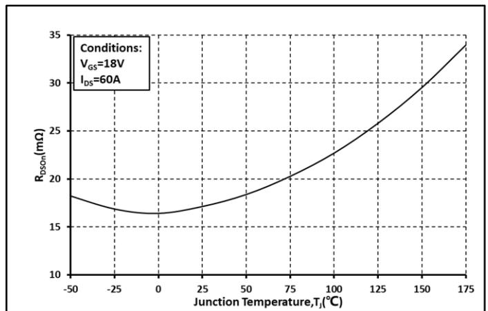
图. 4  $R_{on}$  和温度关系曲线
