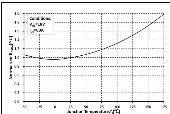
图. 5 归一化的  $R_{on}$  和温度关系曲线
