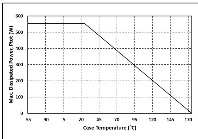
图. 24 最大功耗降额和温度关系曲线
